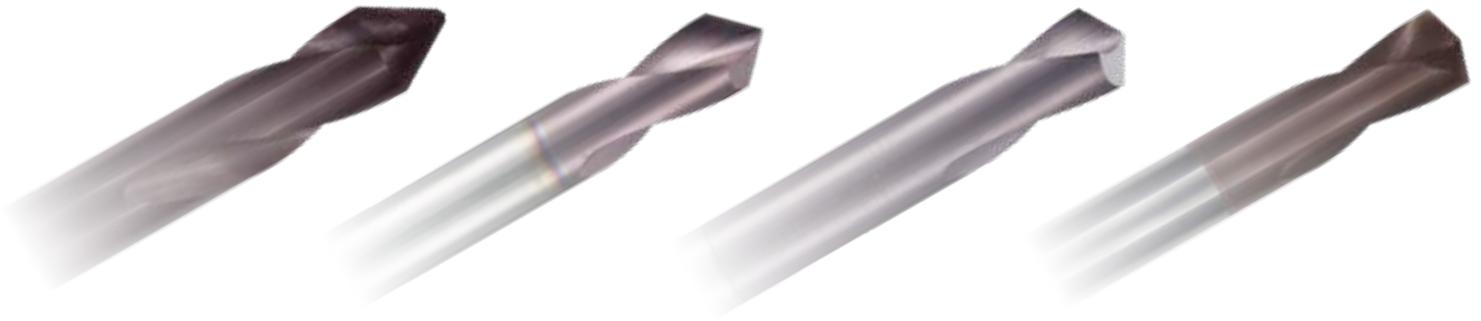
NC機械による正確な位置決めのためのセンタ穴加工には、剛性が高くしかも高精度で高品質な工具が必要となります。ゲーリングのNC-スポットティングドリルは、ハイス・コバルトハイス・超硬等の素材で各種コーティングのレギュラ及びロングシリーズを取り揃えております。また、加工被削材や加工用途に応じて60°/90°/120°/145°の先端角が選定可能です。
