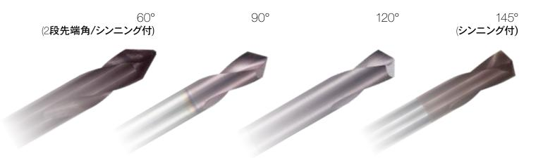
NC機械による正確な位置決めのためのセンタ穴加工には、剛性が高くしかも高精度で高品質な工具が必要となります。 グーリングのNC-スポッティングドリルは、ハイス・コバルトハイス・超硬等の素材で各種コーティングのレギュラ及びロン グシリーズを取り揃えております。また、加工被削材や加工用途に応じて60°/90°/120°/145°の先端角が選定可能です。
