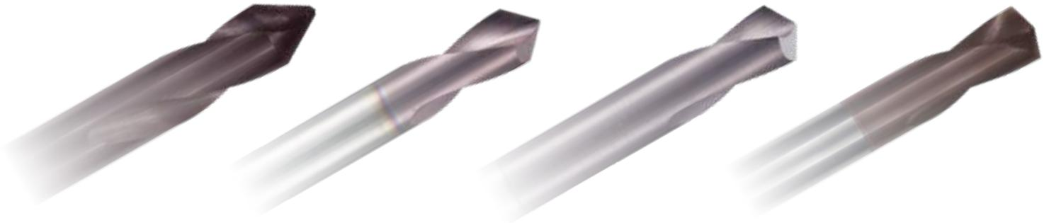
NC機械による正確な位置決めのためのセンタ穴加工には、剛性が高くしかも高精度で高品質な工具が必要となります。グーリングのNC-スポットティングドリルは、ハイス・コバルトハイス・超硬等の素材で各種コーティングのレギュラ及びロングシリーズを取り揃えております。また、加工被削材や加工用途に応じて60°/90°/120°/145°の先端角が選定可能です。
